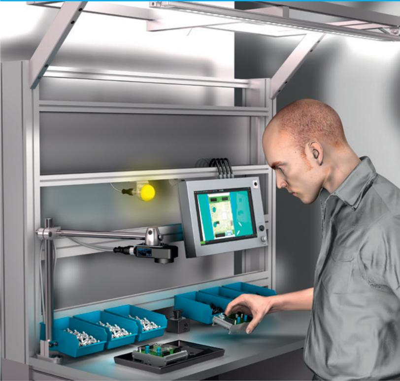
在装配过程中，信号灯亮起黄色；当确认装配步骤已正确执行时，信号灯亮起绿色，系统启动下一步，制定新的规范。但如果在装配过程中出现错误，则会立即通过亮起（可能闪烁）红色的 IO-Link 信号灯显示相应提示以便修正。
