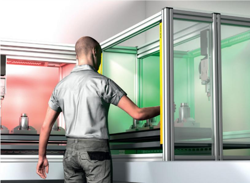
如果在加工单元内加工工件，可将 SB-RGB 用作光学危险指示器。单元亮红色表示对操作员有危险。单元亮绿色时，操作员可以从单元中取出工件。通过这种方式可以避免错误操作并提高系统可用性。
