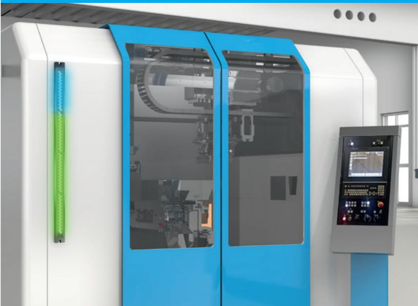
在加工中心，信号灯可在分段模式下显示进度。机器操作员可以立即查明当前状态并在出现错误消息时采取相应措施。通过分段可以清晰地光学显示大量信息。
