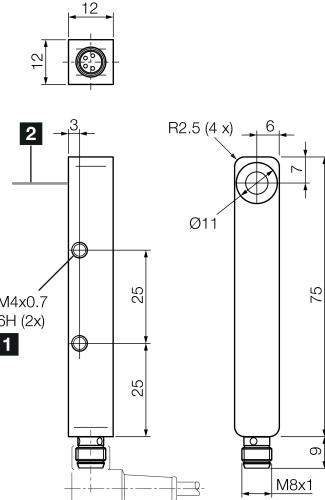
1) Bohrung / Gewinde (durchgehend) / Boring / thread (continuous) / Alésage / Filetage (traversant)
