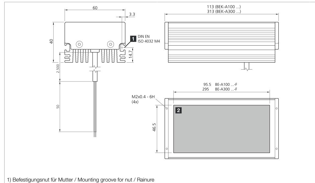
1) Befestigungsnut für Mutter / Mounting groove for nut / Rainure de fixation pour écrou
