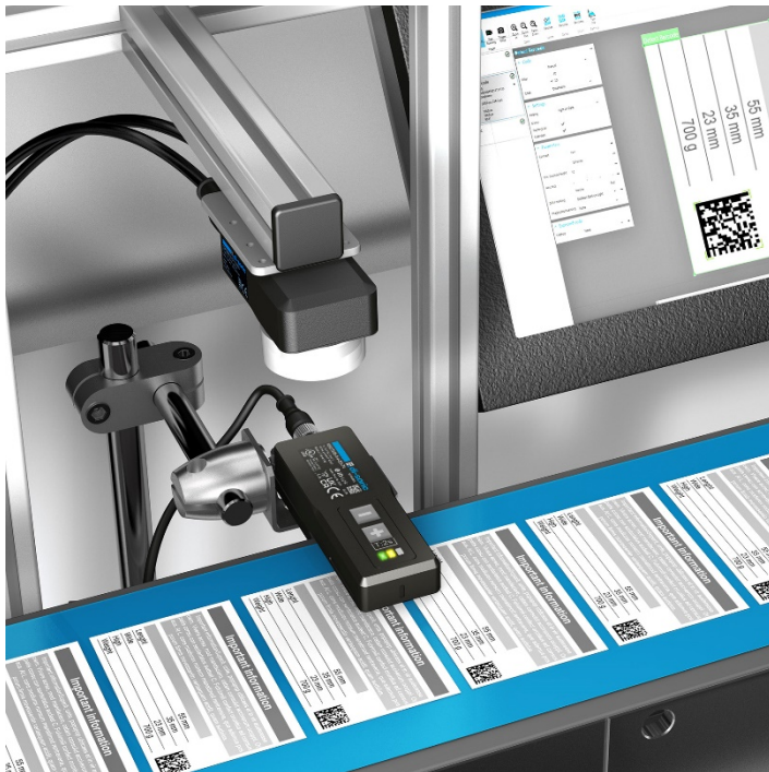
Bild 2: Präzise Triggerung von Kamerasystemen mit kapazitivem Etikettensensor KGUT150.
