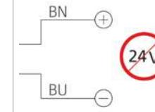
Betrieb ausschließlich mit Flash-Controller an einem Supply Class 2 - Netzteil!
