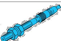
Der Sensor darf in beliebiger Einbaulage montiert werden, hierbei ist eine erschütterungsfreie und schwingungsdämpfende Montage zu beachten.
