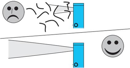
Die Wandleroberfläche sowie der Bereich der Detektionskeule ist zwingend frei zu halten. Es ist darauf zu achten, dass keinerlei störende Objekte zwischen dem Sensor und dem Zielobjekt innerhalb der Keule sind.
