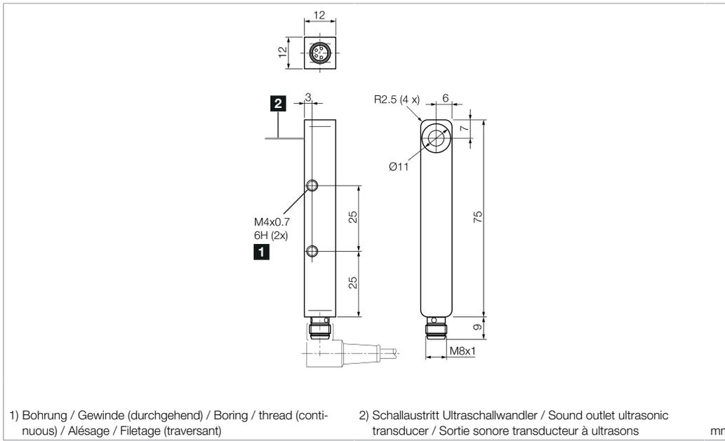
1) Bohrung / Gewinde (durchgehend) / Boring / thread (continuous) / Alésage / Filetage (traversant) 2) Schallaustritt Ultraschallwandler / Sound outlet ultrasonic transducer / Sortie sonore transducteur à ultrasons mm
