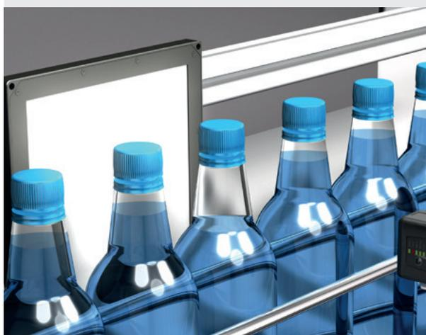
Contrôle de la hauteur de remplissage et de la position du bouchon
