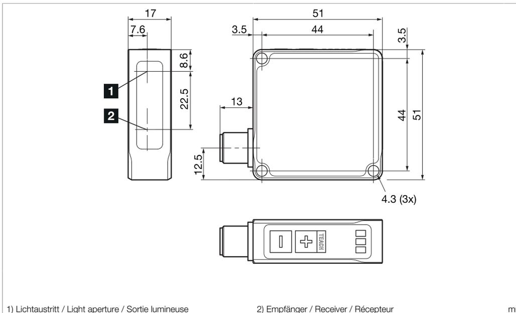
1) Lichtaustritt / Light aperture / Sortie lumineuse
